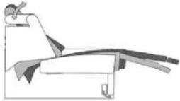
Durch Körperdruck auf den oberen Rückenbereich kann der Rücken anschließend bis zur Liegeposition geöffnet werden, der Sitz fährt in dieser Bewegung weiter mit nach vorne und oben. Der Rücken bleibt weiterhin wandfrei.
